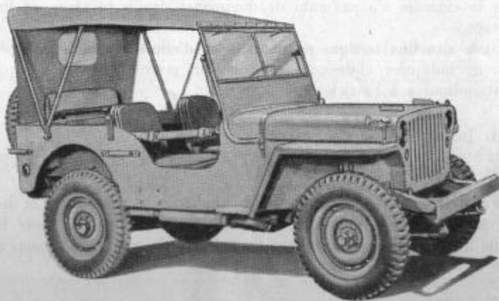
Fig. 2. — Voiture de liaison de 1/4 de tonne, à 4 roues motrices. Vue de trois quarts (avant droit)
